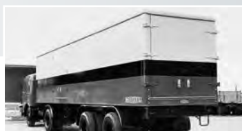
Il primo semirimorchio refrigerato realizzato interamente in plastica
