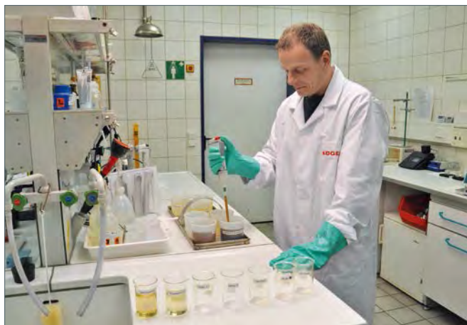
Nel laboratorio di verniciatura KTL, tutti i parametri prescritti dei bagni vengono controllati continuamente.
