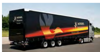
La leggerezza della costruzione Phoenix:.....telaio del pianale, collo, parete anteriore e porte posteriori in carbonio
